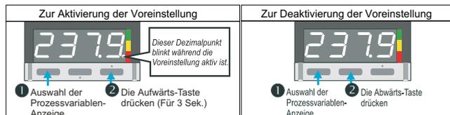
**HINWEIS:** Die Vorabstimmung ist eine monostabile Funktion und deaktiviert sich automatisch selbst nach Beendigung seiner Routine. Die Vorabstimmung wird nicht aktiviert, wenn (a) die Prozessvariable innerhalb von 5% der Eingangsspanne des Sollwertes liegt, (b) die Einheit für Ein/Aus-Steuerung konfiguriert ist oder (c) die einfache Abstimmung ausgewählt ist.
